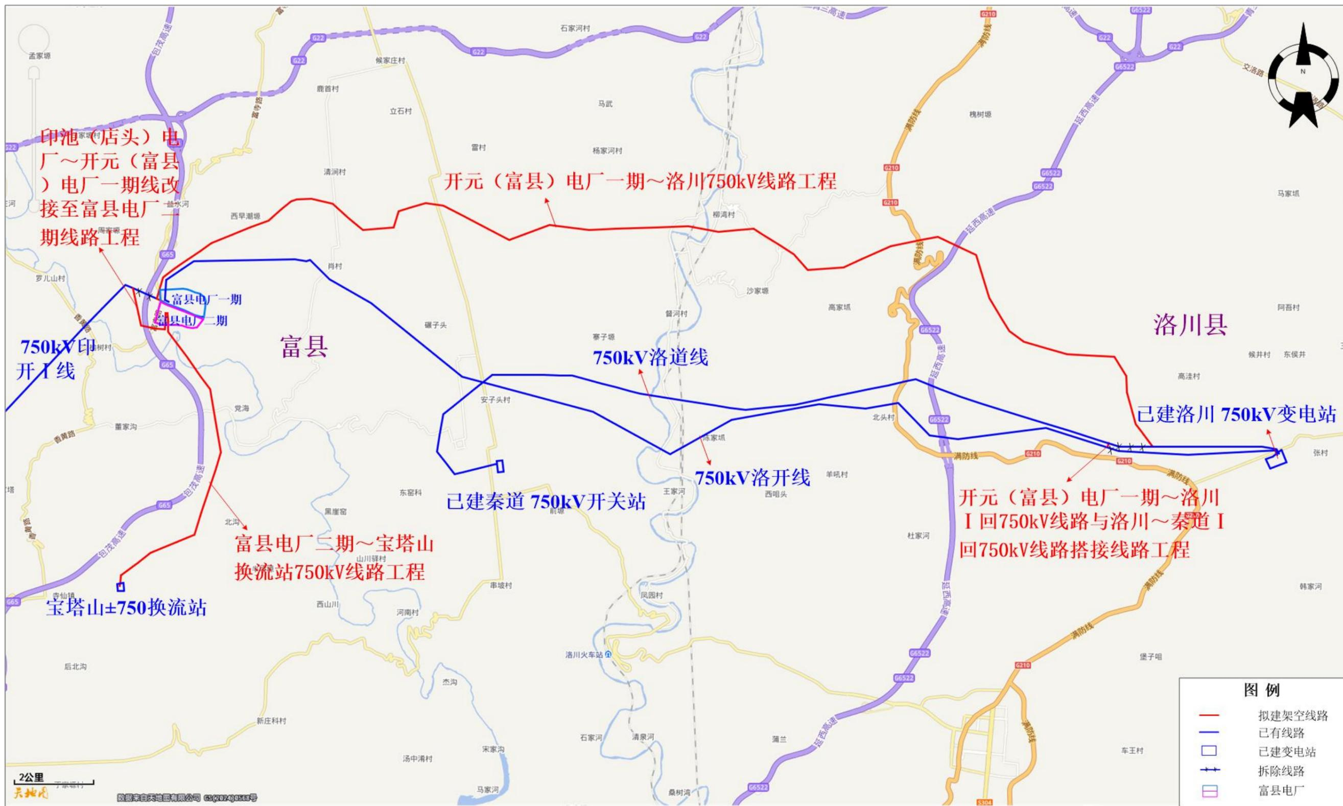
图 3.1-1 本工程 750kV 输电线路路径示意图
